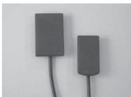
Рис. 2. Рентгеночувствительная CCD-матрица различных размеров в качестве приемника рентгеновского изображения
